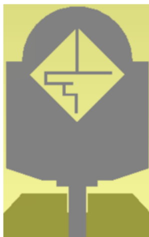
(d) Antenna-4 with single notch band (n78)
